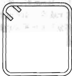
图 4.4.1-4 有抗震等要求的箍筋加工结构
