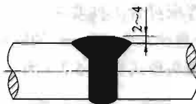
图 5.2.7 钢筋电弧窄间隙焊接头 (单位: mm)
