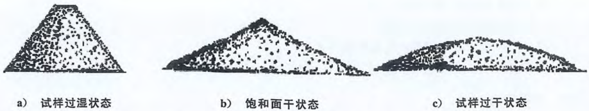
图4 天然砂饱和面干状态示意图
