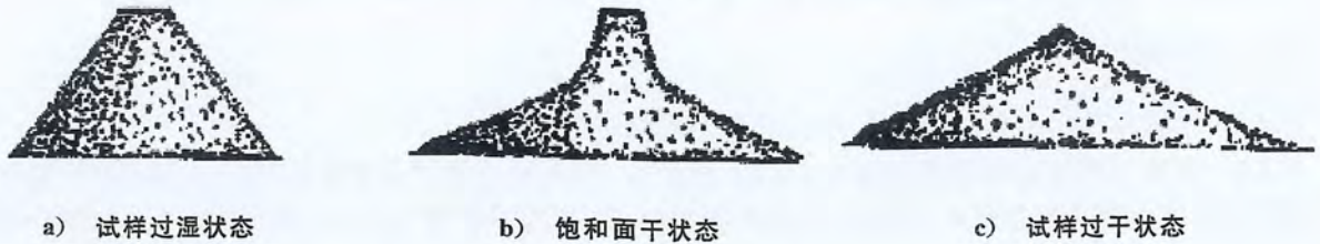
图5 机制砂饱和面干状态示意图
