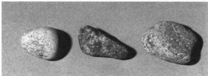
图 T 0346-9 无破碎面(圆颗粒、光滑表面)
