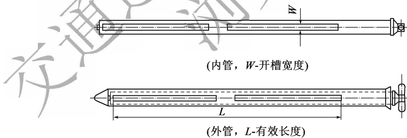
图 T 0301-1 带开槽的取样管示意图
